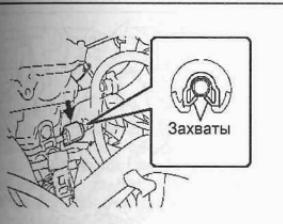
**Снятие и установка форсунок (1ZR-FE).** 1 - крышка №2 головки блока цилиндров, 2 - жгут проводов двигателя, 3 - проставка, 4 - топливный коллектор, 5 - кольцевое уплотнение, 6 - форсунка, 7 - топливопровод, 8 - зажим (типа А), 9 - зажим (типа В).
